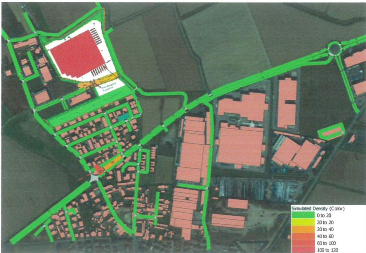
Figura 32 – Scenario di progetto: densità rete stradale area di studio
